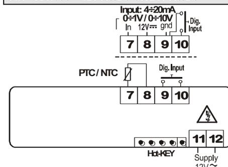
Probe: Pt100= 7 – 9 (8); Thermocouple J, K, S = 7(+); 9(-)
